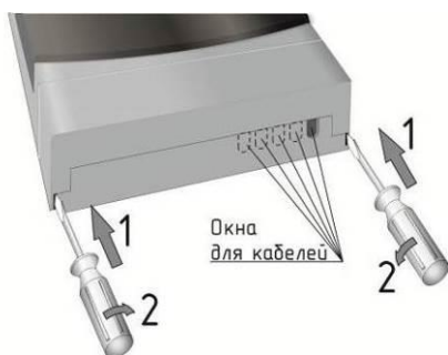
Рисунок 4 – Снятие крышки клеммного отсека
