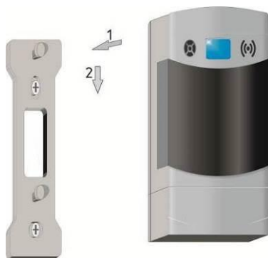
Рисунок 5 – Установка сигнализатора на монтажную панель
